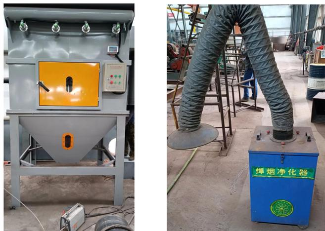
图 7 布袋除尘器和移动式焊烟净化器
